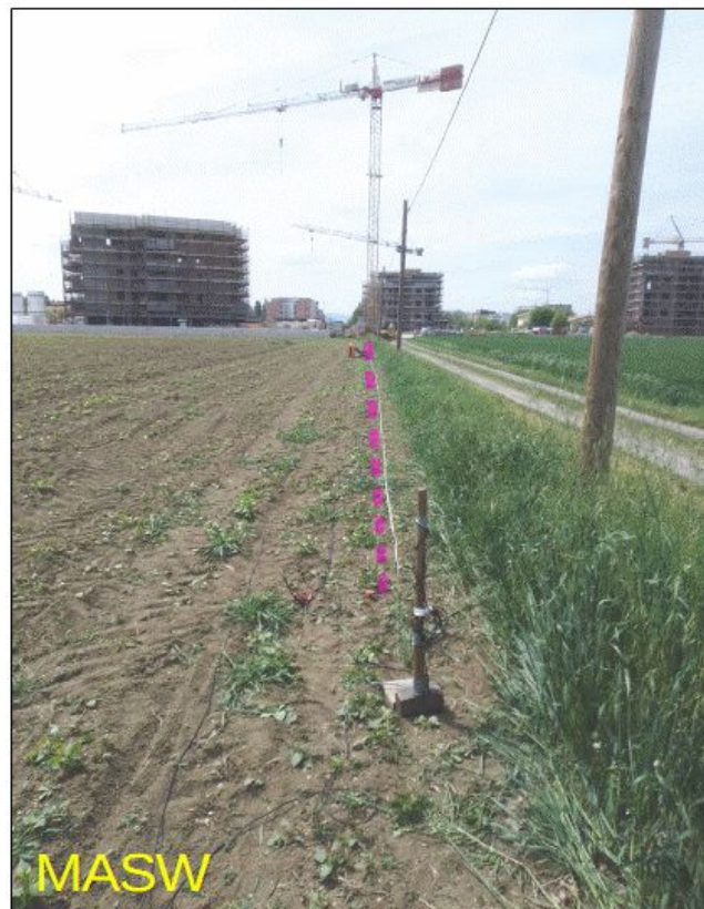
Foto 2.2 - Stendimento sismico MASW/ReMi eseguito per questo studio
