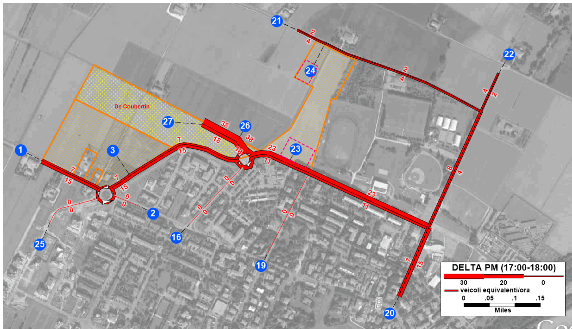
Figura 11- Flussogramma delta veicolare imputabile al sub-ambito "De Coubertin" (ora di punta PM)
